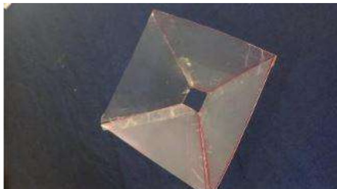
Figura 1 - Instrumento elaborado para projetar holografia.
