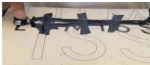
Figura 1. Circuito elétrico simples com apenas um único LED, feito na tampa da caixa de sapato.
