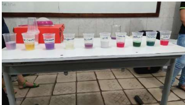
Figura 1. Coloração final das amostras utilizadas na prática de indicadores ácido-base com extrato de repolho roxo
