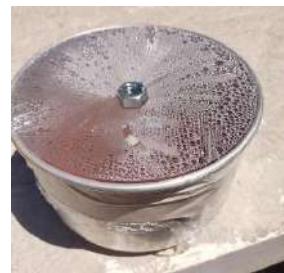
Figura 2. Destilador solar exposto ao sol
