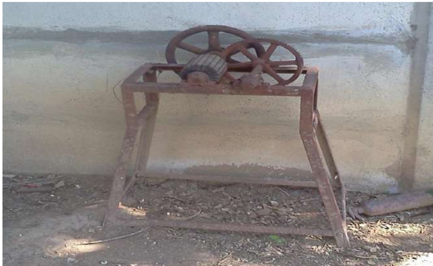
Ralador Manual de Mandioca – usado ao longo das décadas de 1970-80 – trabalho familiar
