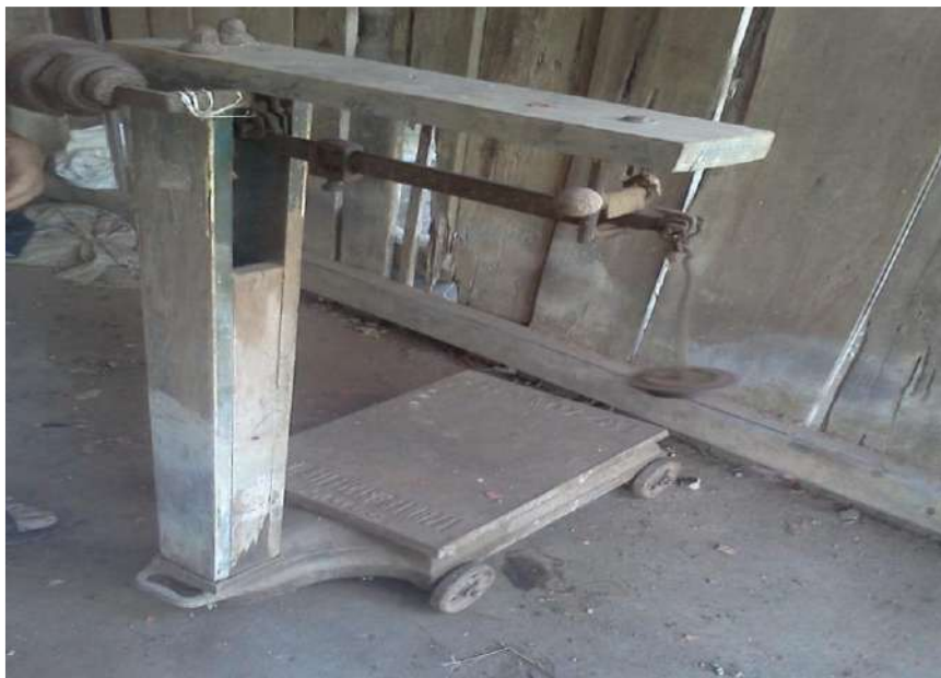
Modelo de balança utilizada pelos fazendeiros para pesagem dos produtos cultivados e animais de pequeno porte.
