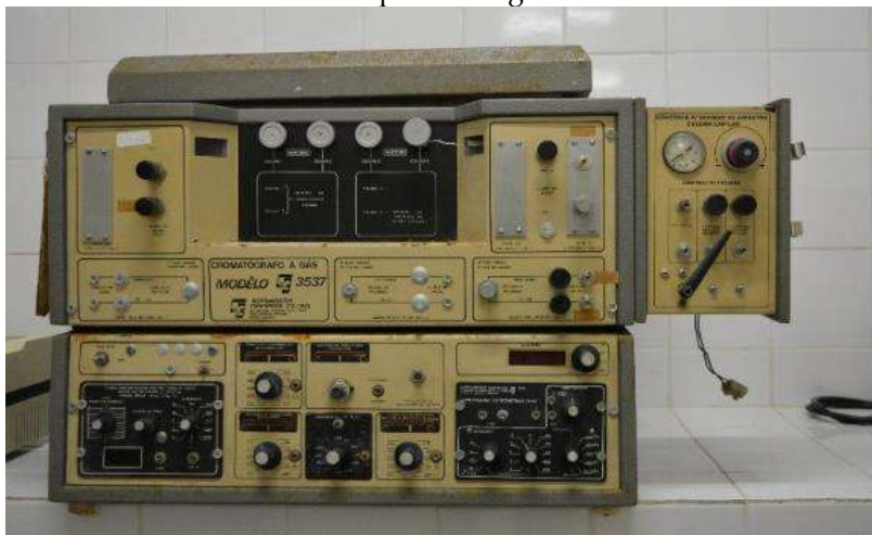
Figura 1 – Cromatógrafo a gás modelo C.G. Ltda. Utilizado pelo laboratório de química orgânica do ITPS.
