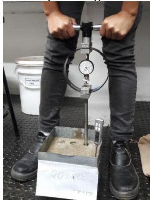
Figura 2. Penetração da agulha na argamassa
