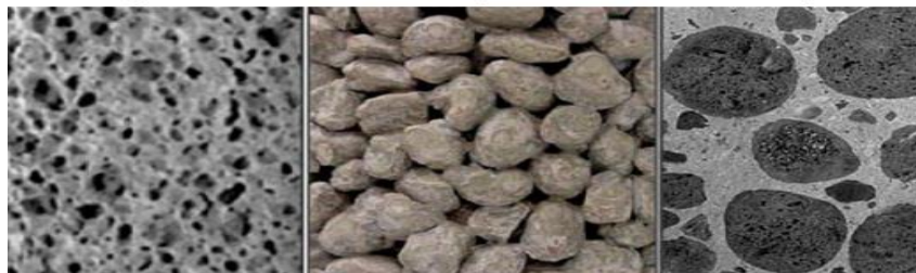
Figura 1 – Imagens de Concreto leves: a) Concreto celular ou aerado; b) Concreto sem finos; c) Concreto com agregado leve
