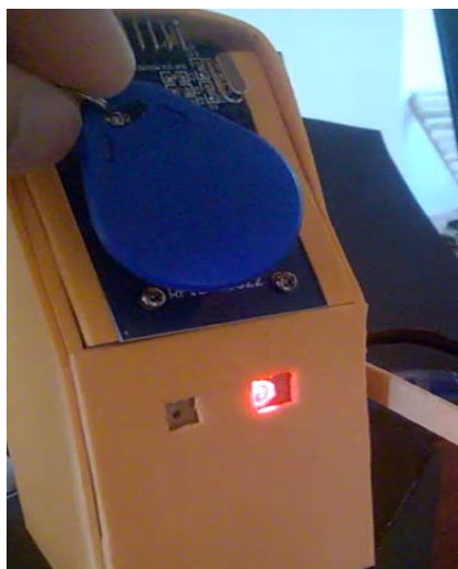
Figura 9: Ação negada ao ler um cartão não cadastrado no sistema
