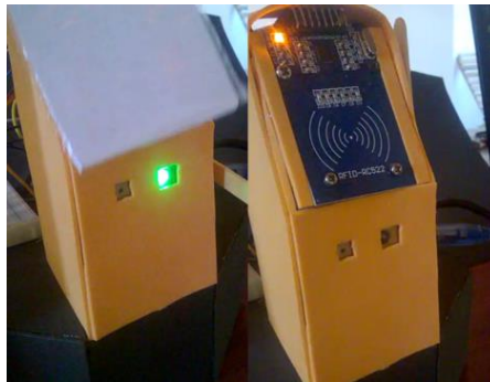
Figura 8: Ação de liberação ao ler um cartão cadastrado no sistema
