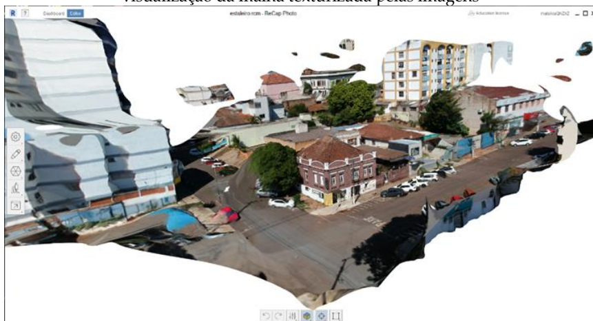
Imagem 3 – Modelo 3D gerado pelo software Autodesk Recap Photo , com a visualização da malha texturizada pelas imagens
