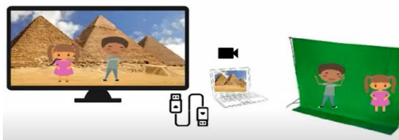
Figura 2 – Esquema de utilização do OBS Studio com o chroma key e um televisor Fonte: as autoras (2020).
