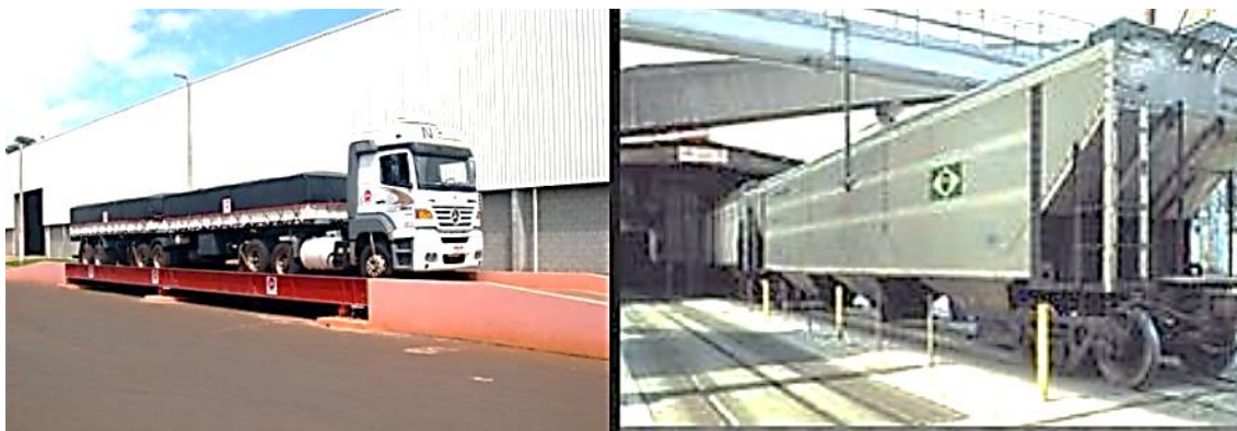
Figura 8. Pesagem da carga nas balanças estáticas rodoviária e ferroviária.
