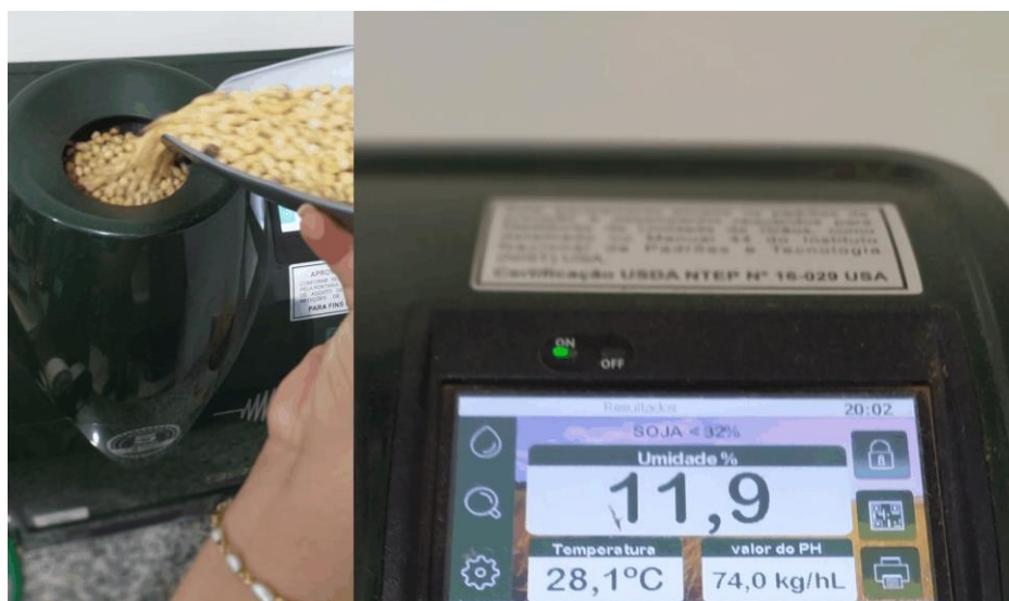
Figura 21. Determinadores de Umidade Digital.
