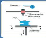
**As impressoras 3D FDM / FFF (modelagem por deposição fundida)**
