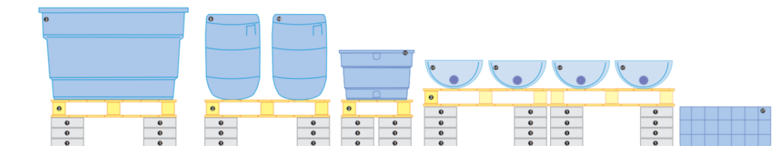
Figura 10 - Instalação dos tanques sob a base do sistema aquapônico
