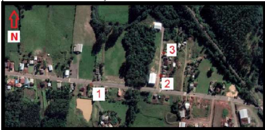
Figura 8 - Pontos capturados para obter os níveis de inundação. 1, 2 e 3: pontos históricos de inundação reconhecidos
