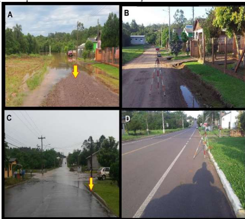
Figura 7: Inundação e captura de dados para obter a altitude de inundação do arroio. A) Inundação ocorrida em 2016 na Rua Edvino Kord; B) Captura dos dados espaciais para determinar a altitude de inundação; C) Inundação ocorrida em 2016 na Rua 4 de Julho; D) Captura de dados espaciais para obter a altitude de inundação
