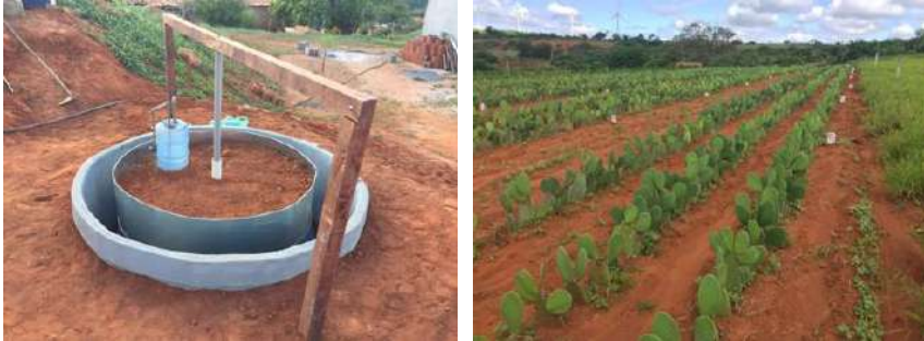
Figura 5. Biodigestor construído na comunidade rural no Semiárido para produção de biofertilizantes de esterco bovino (esquerda); Palma forrageira cultivadas com diferentes volumes de biofertilizantes no Semiárido (direita)
